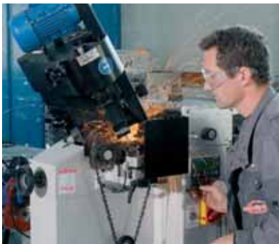
Dirk Ledderhose, Mitarbeiter des Service-Zentrums am neuen Sägekettenschärfautomat.
